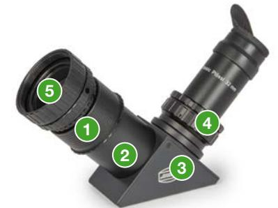
Der Universal Alan Gee (1) wird über eine optionale 40mm-Verlängerungshülse (2) an das T-2-Prisma (3) angeschlossen. Der Anschluss an das Teleskop erfolgt entweder über den BTA-Adapter für Schmidt-Cassegrains #2408160 (4) oder über die 2"-Steckhülse des UAG.
