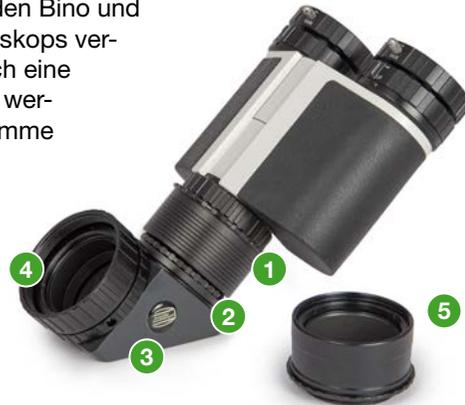
Der Universal Alan Gee (1) wird über eine 7,5mm-Verlängerungshülse (2) an das T-2-Prisma (3) angeschlossen. Der Anschluss an das Teleskop erfolgt entweder über den BTA-Adapter für Schmidt-Cassegrains #2408160 (4) oder über die 2"/T-2-Steckhülse #2408150 (5).
