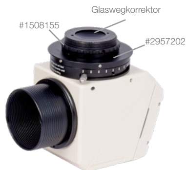
Die Glaswegkorrektoren für Binokularansätze mit T-2-Anschluss und der 2,6x Glaswegkorrektor werden in den T-2 Zwischenring 7,5mm #1508155 eingelegt. Der Binokularansatz kann direkt an das T-2-Gewinde oder über einen T-2-Schnellwechsler angeschlossen werden.
