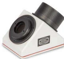
Zenitspiegel mit T-2-Adapter und eingebautem Glaswegkorrektor
