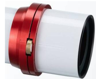
Der Etalon des LS40THa wird beim Drehen des Rädchens ziemlich schnell gekippt. Drehen Sie deshalb nur sehr langsam an diesem Rädchen, um den optimalen Tuning-Punkt nicht zu verfehlen.
